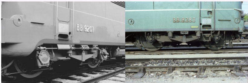
Photos : Comparaison entre bogies et marchepieds d'origine et la version modernisée - Coll. J.M. Steiner et B. Bayle -
